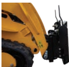
D006489 - PLAQUE DE MONTAGE AVANT BAUMALIGHT À MODIFICATEUR D'ANGLE MÂLE POUR MINI CHARGEUR BOBCAT
